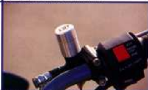
Première création signée KMP, le bocal taillé masse pour les maîtres-cylindres de frein ou d'embrayage.
