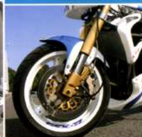
>>> Du top pour le freinage : disques Brembo et étriers Nissin six pistons.
