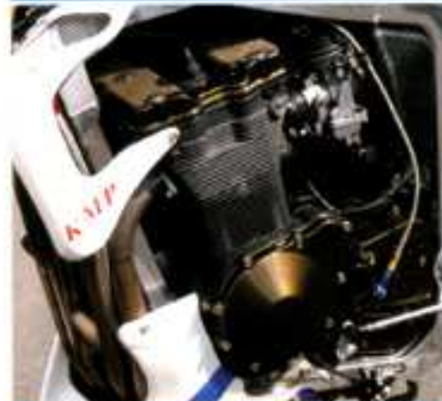
>>> Le moteur reçoit un cache-culbuteurs et des carfers de couleur bronze, ainsi qu'un filtre à air K&A. Les durites de refroidissement sont du type aviation.
