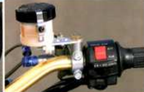
>>> Mini boiler de cockpit de frein avec maître-cylindre Nissin.
